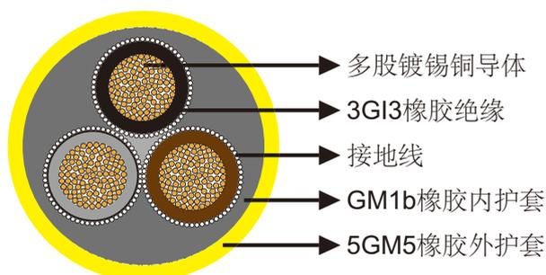
导体：DIN VDE 0295标准class 5柔软多股铜导体。
